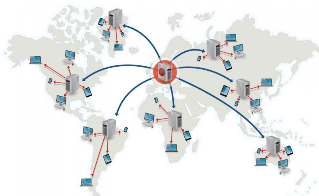
Figura 3: Esquema de funcionamento das redes de distribuição de conteúdo.
